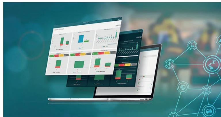
Eine weitere Art, wie HxGN SMART Quality die gewonnenen Daten direkt nutzt, ist die einfache Darstellung von Messdaten in Rot und Grün auf einem Dashboard. So werden Abweichungen von Spezifikationen auf einen Blick erkannt und rot dargestellt. Drilldown-Funktionalitäten erlauben das Abtauchen in weitere Details. Falls erforderlich können Korrekturmaßnahmen sofort vor Ort eingeleitet werden und mögliche Verbesserungen werden direkt im Werk ersichtlich.
