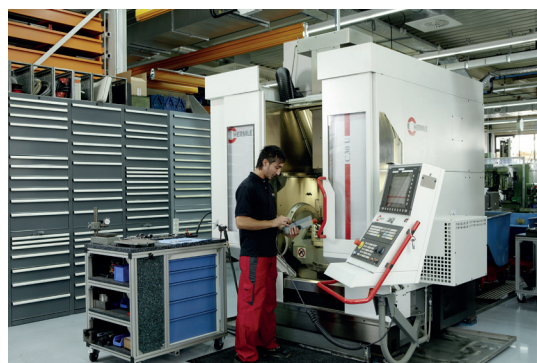
Für spezielle Anwendungsfälle stehen ein Sondermaschinenpark und mehrere Hermle 5 Achs-Bearbeitungszentren zur Verfügung.
